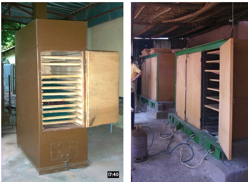
Fig. 8 : Séchoirs à gaz utilisés par les unités de transformation des céréales et produits horticoles : type Atesta (à gauche) et type FAC 2000 (à droite).
