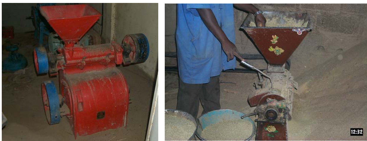
Fig.1 : Matériels de décortilage couramment utilisés par les unités de transformation des céréales : décortiqueurs de type Engelberg importé (à gauche) et de fabrication locale (à droite).
