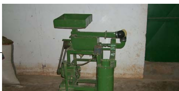
Fig.1 : Matériels de décortilage couramment utilisés par les unités de transformation des céréales : décortiqueurs de type Engelberg importé (à gauche) et de fabrication locale (à droite).
