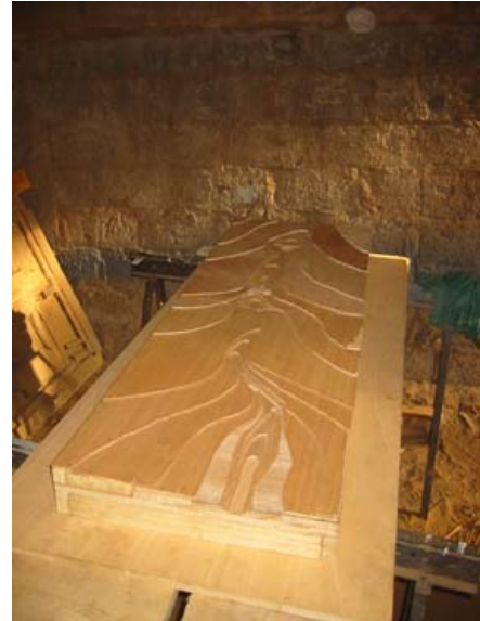
Figuration du relief (courbes de niveau) par superposition de lames de contreplaqué
